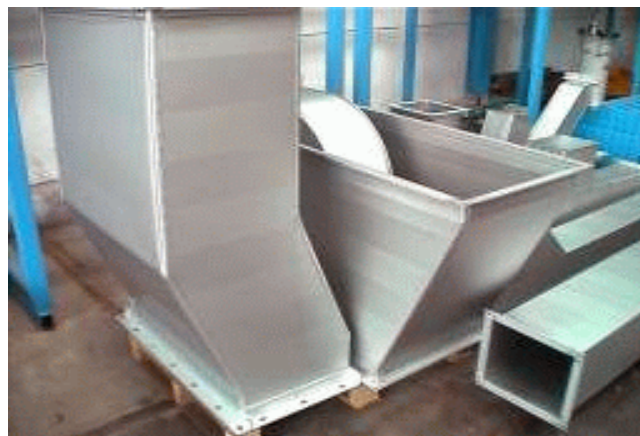
Grondig gereconditioneerde schachten (foto: Vecom Maassluis).
